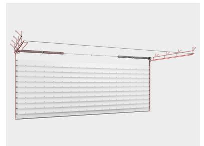
Эксклюзивная опция — силовая монтажная конструкция с системой захвата полотна обеспечивает жесткое положение горизонтальных направляющих при динамических нагрузках и дополнительную страховку от падения полотна ворот.
