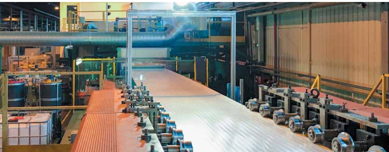
Линия профилировки и кромкозагибки PIR-панелей
