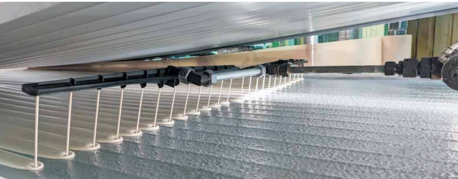
Цех производства PIR-панелей, участок смешения и заливки PIR-компонентов
