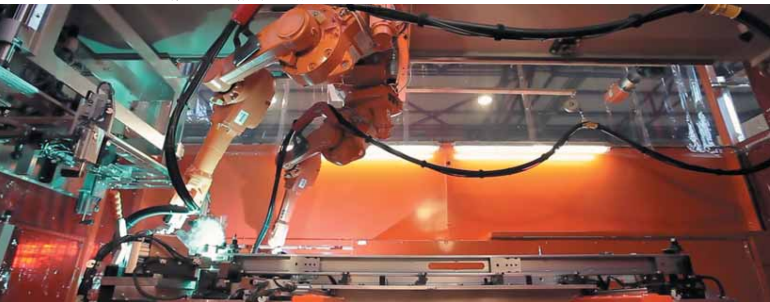
Завод дверных систем, цех производства дверных рам, роботизированная линия сварки дверной рамы
