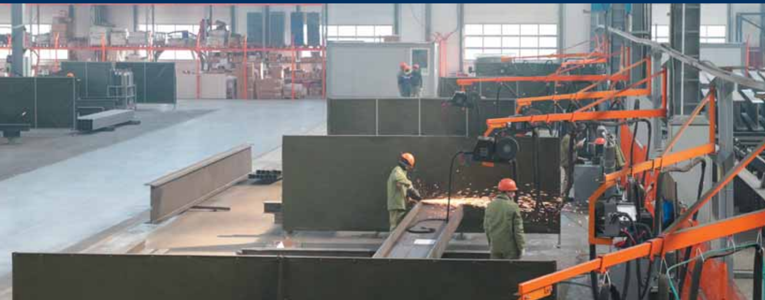
Завод полнокomплектных зданий, сборо-сварочный цех
