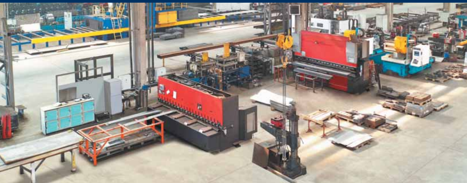
Завод блочно-модульных зданий, станки листогибочные
