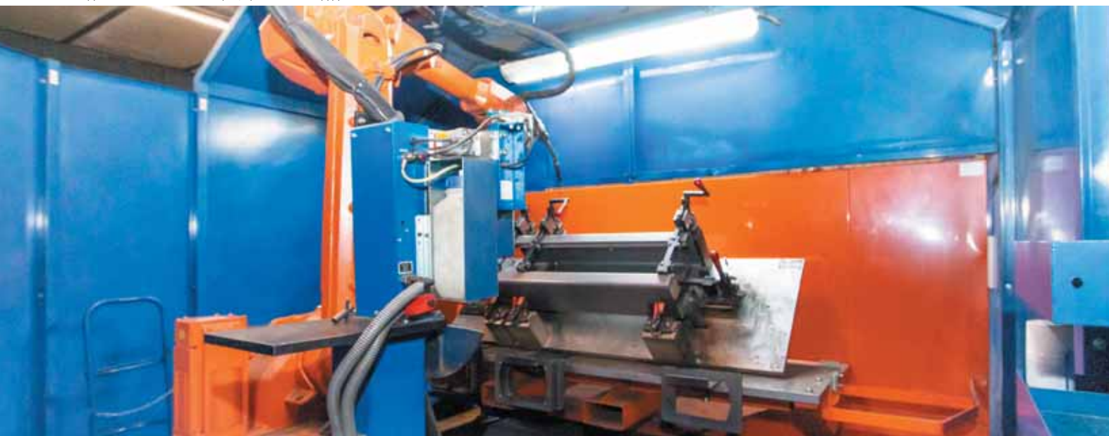
Завод систем автоматизации, цех роботизированной сварки
