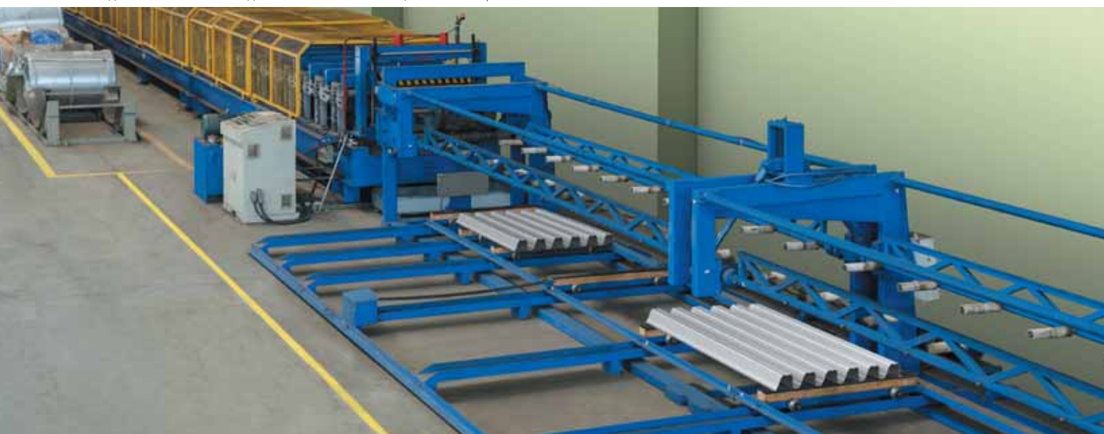
Завод полнокomплектных зданий, цех профилирования, линия изготовления 153-го профиля
