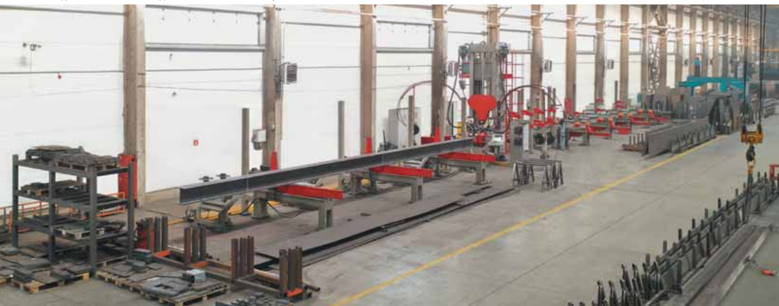
Завод полнокomплектных зданий, линия для изготовления сварной балки
