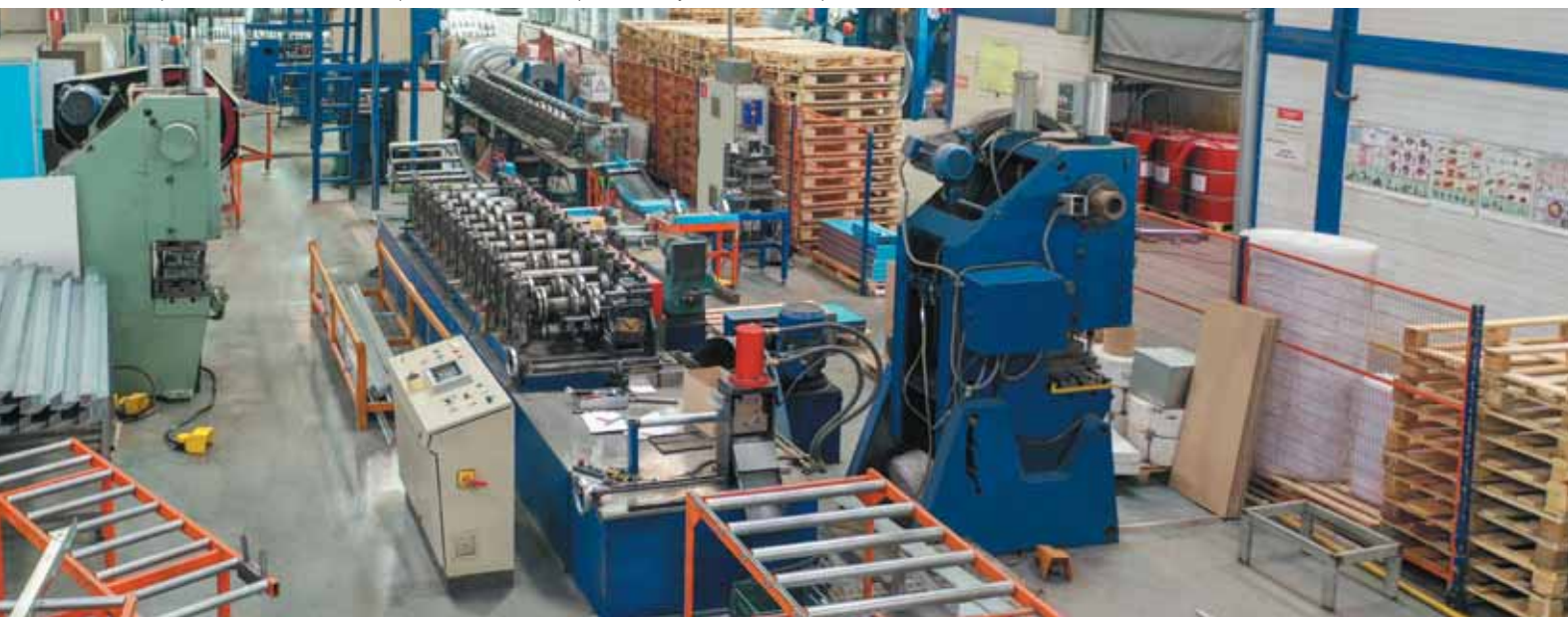
Завод воротных систем, линия профилирования
