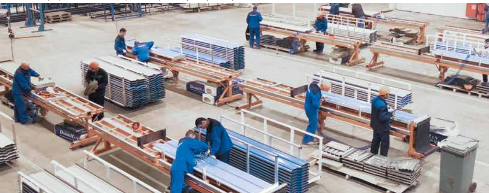
Завод акустических экранов, цех сборки шумозащитных панелей
