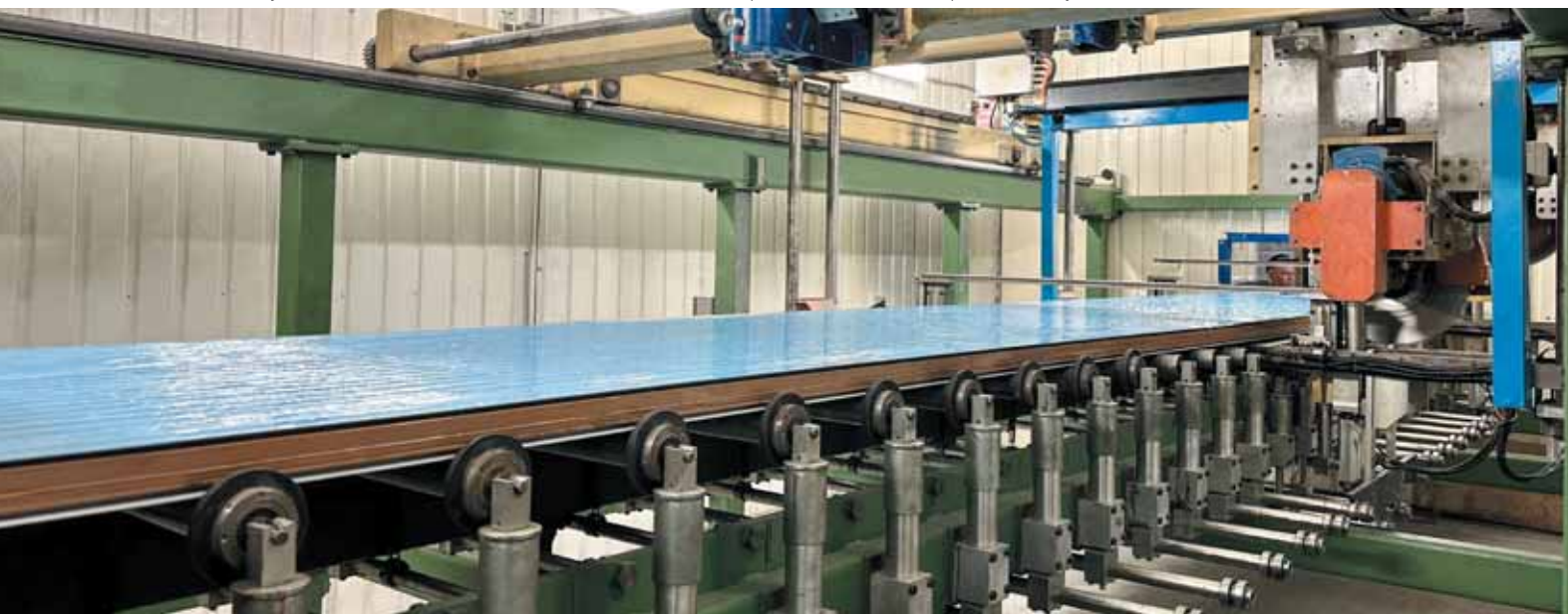
Завод стеновых и кровельных сэндвич-панелей с минеральной ватой и PIR, теплоизоляционных PIR-плит, линия производства сэндвич-панелей PIR и PUR
