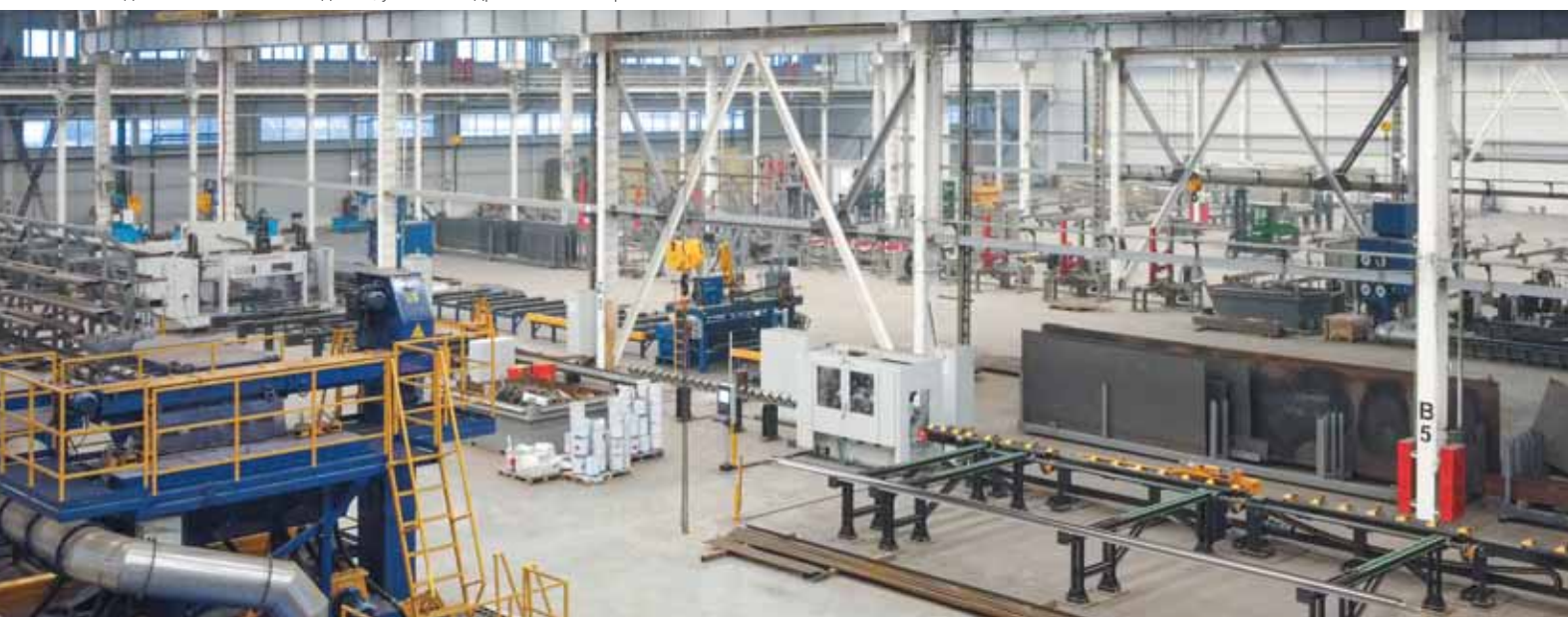
Завод полнокomплектных зданий, автоматическая линия обработки уголкового металлопроката
