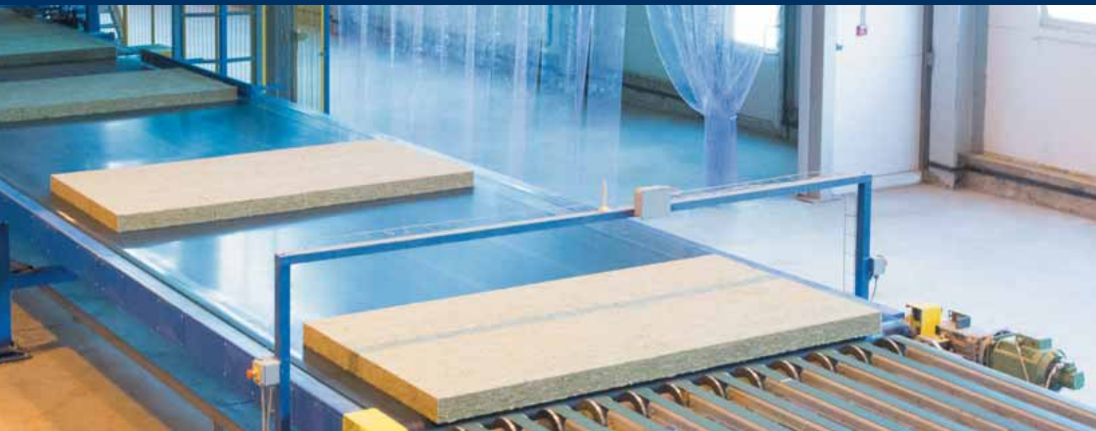
Завод минераловатных плит, автоматическая линия производства минеральной ваты
