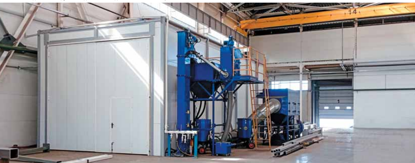
Завод блочно-модульных зданий, камера дробеструйной обработки
