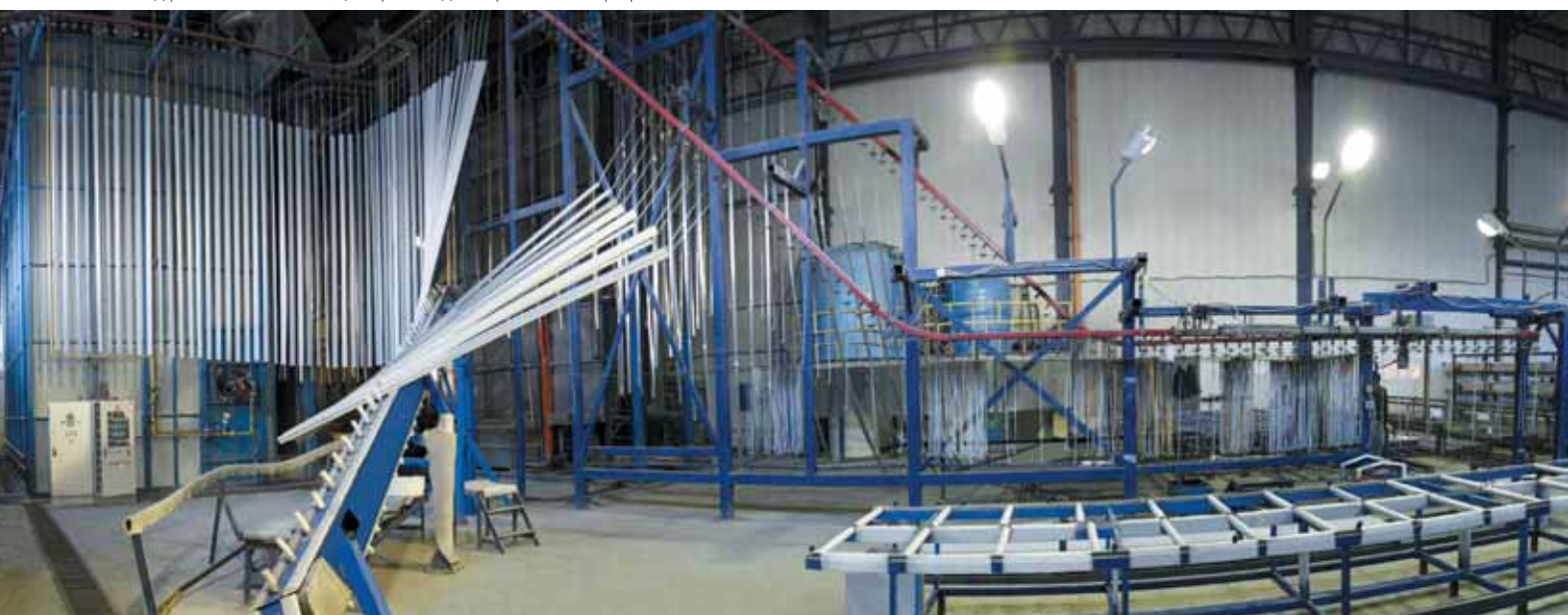
Завод роллетных систем, цех горизонтальной порошковой окраски
