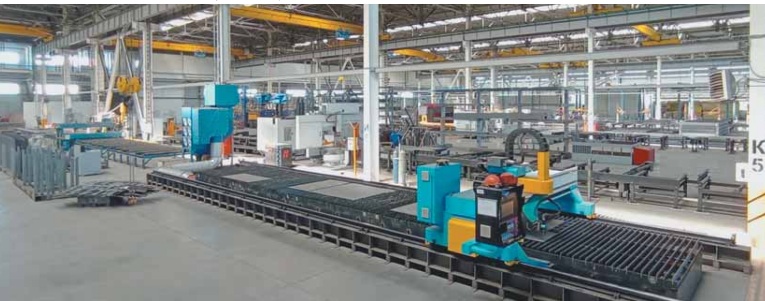
Завод полнocomплектных зданий, станок плазменной резки листового металлопроката с ЧПУ
