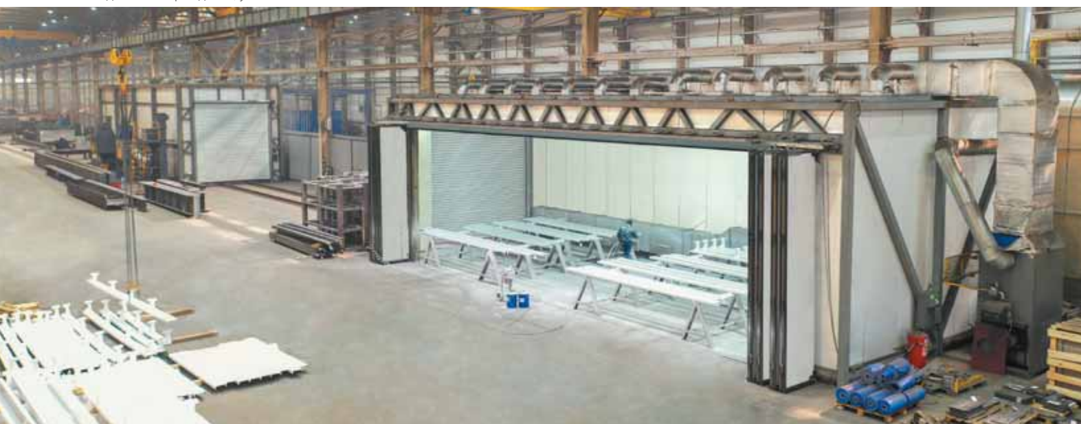
Завод мостовых конструкций, дробеметная установка и камера безвоздушной окраски
