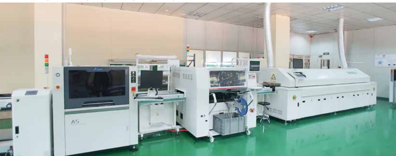
Завод электромеханики и микроэлектроники, линия автоматической установки и пайки SMT-компонентов печатных плат
