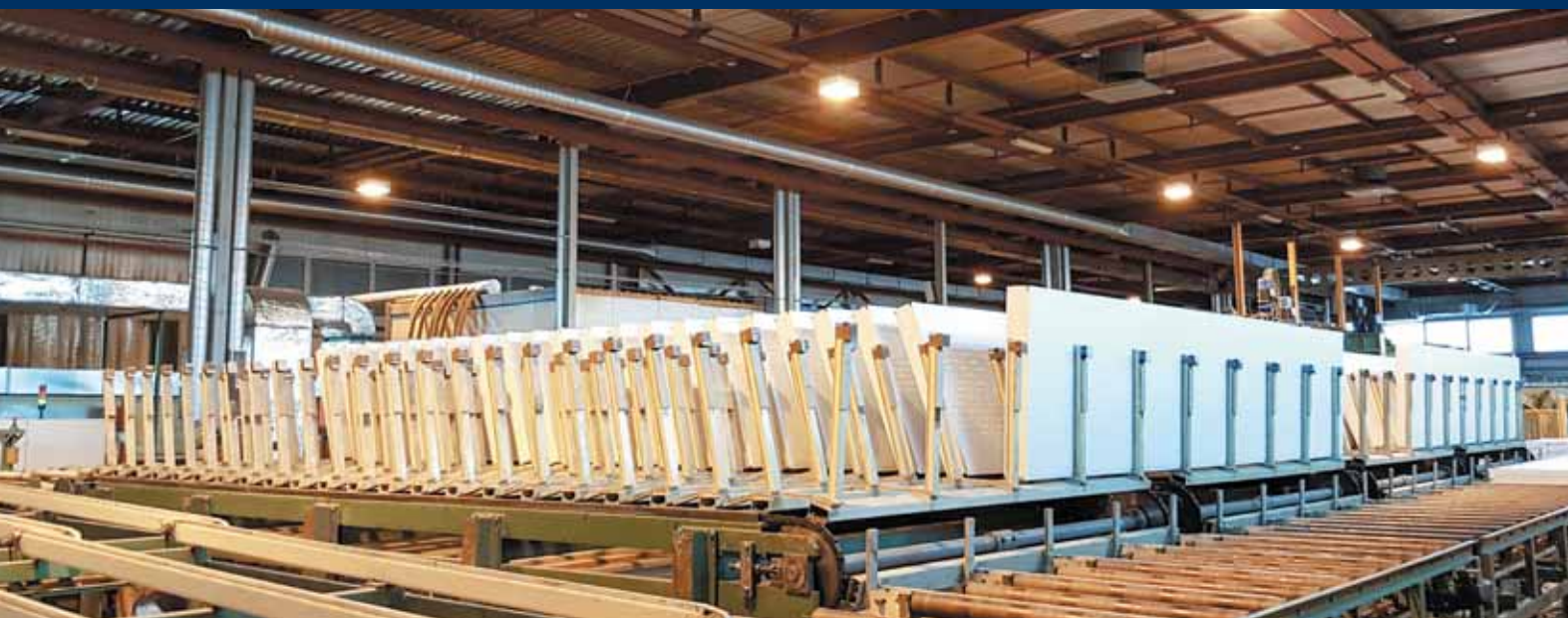
Цех производства PIR-панелей, участок охлаждения готовой продукции
