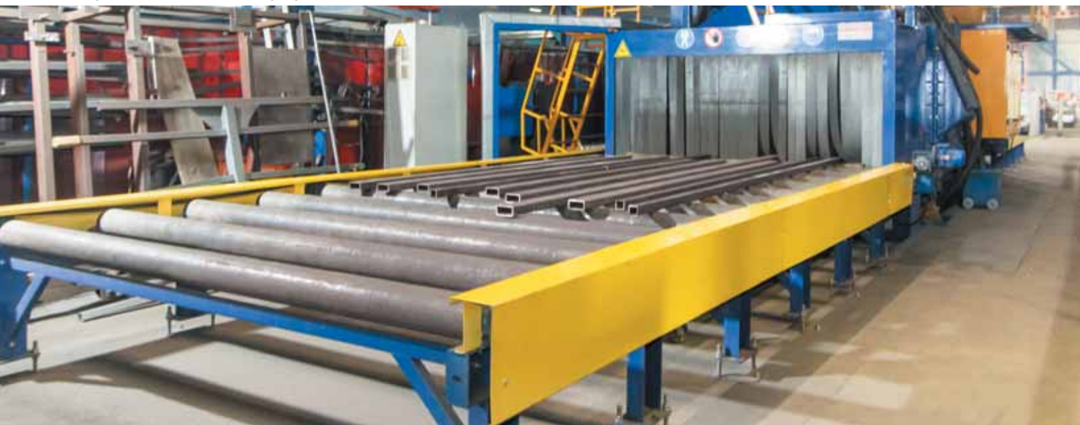
Завод перегрузочного оборудования, заготовительный цех, дробеметная установка
