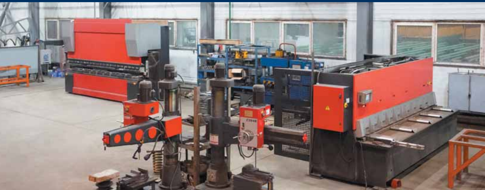
Завод блочно-модульных зданий, гильотина и листогибочный станок, сверлильный станок для производства угловых элементов
