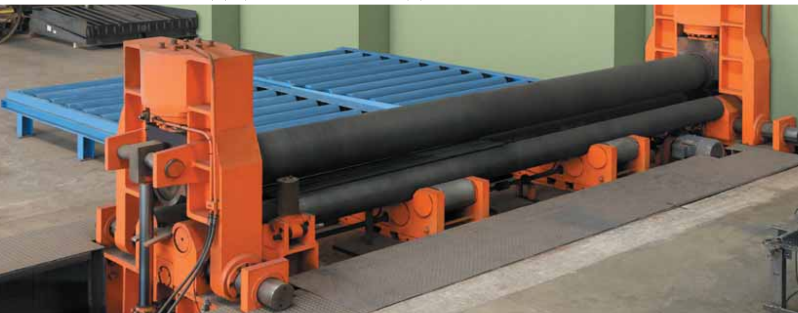
Завод полнокomплектных зданий, трехвалковая установка для гибки стальных заготовок толщиной до 20 мм
