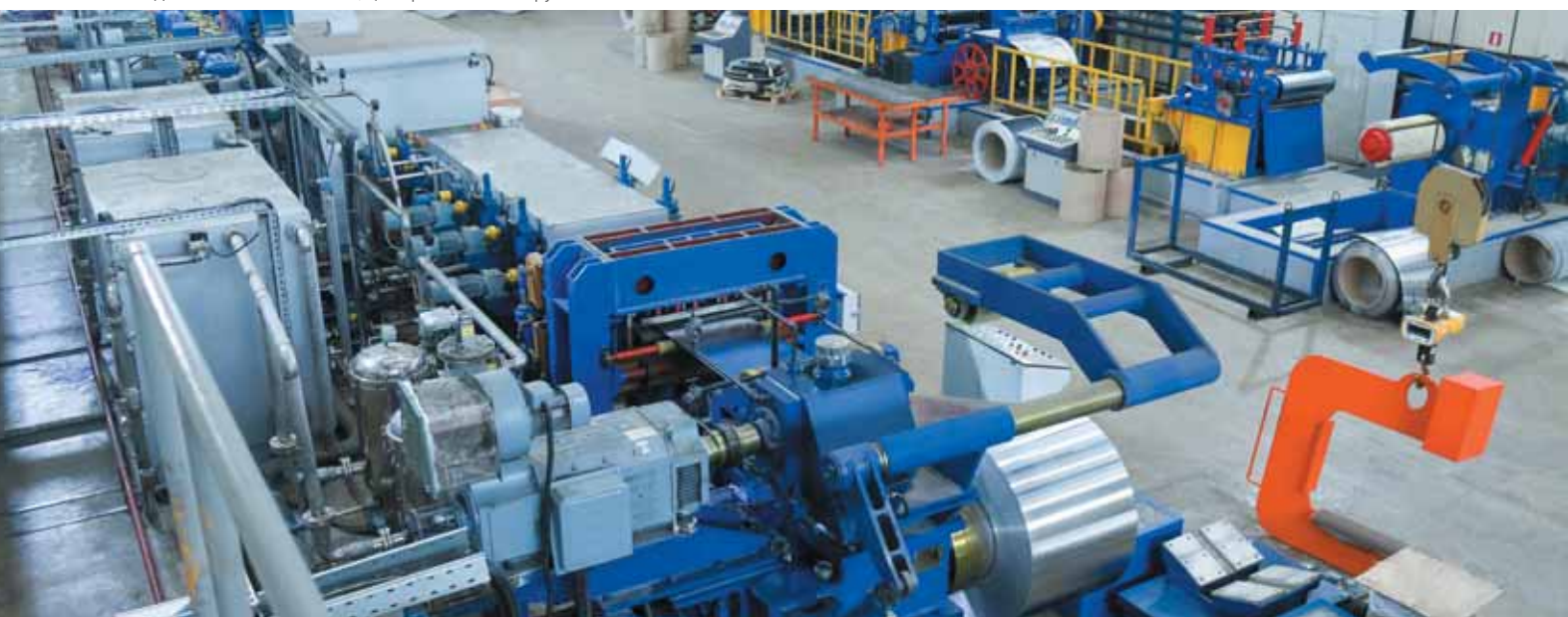
Завод алюминиевых систем, линия правки натяжением алюминиевой ленты
