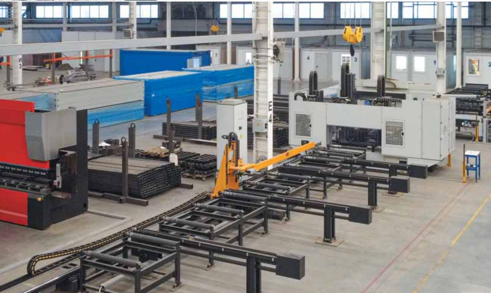
Завод полнокомплектных зданий, цех по производству полнокомплектных зданий, автоматическая линия сверления и пиления профильного металлопроката
