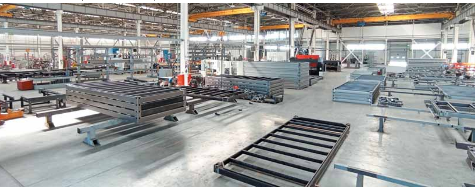
Завод блочно-модульных зданий, сборочный участок
