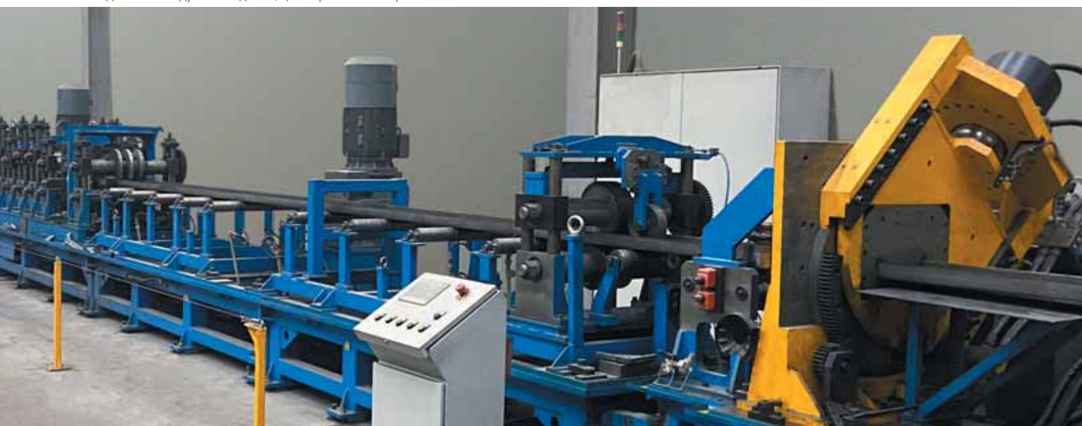
Завод блочно-модульных зданий, цех профильной прокатки
