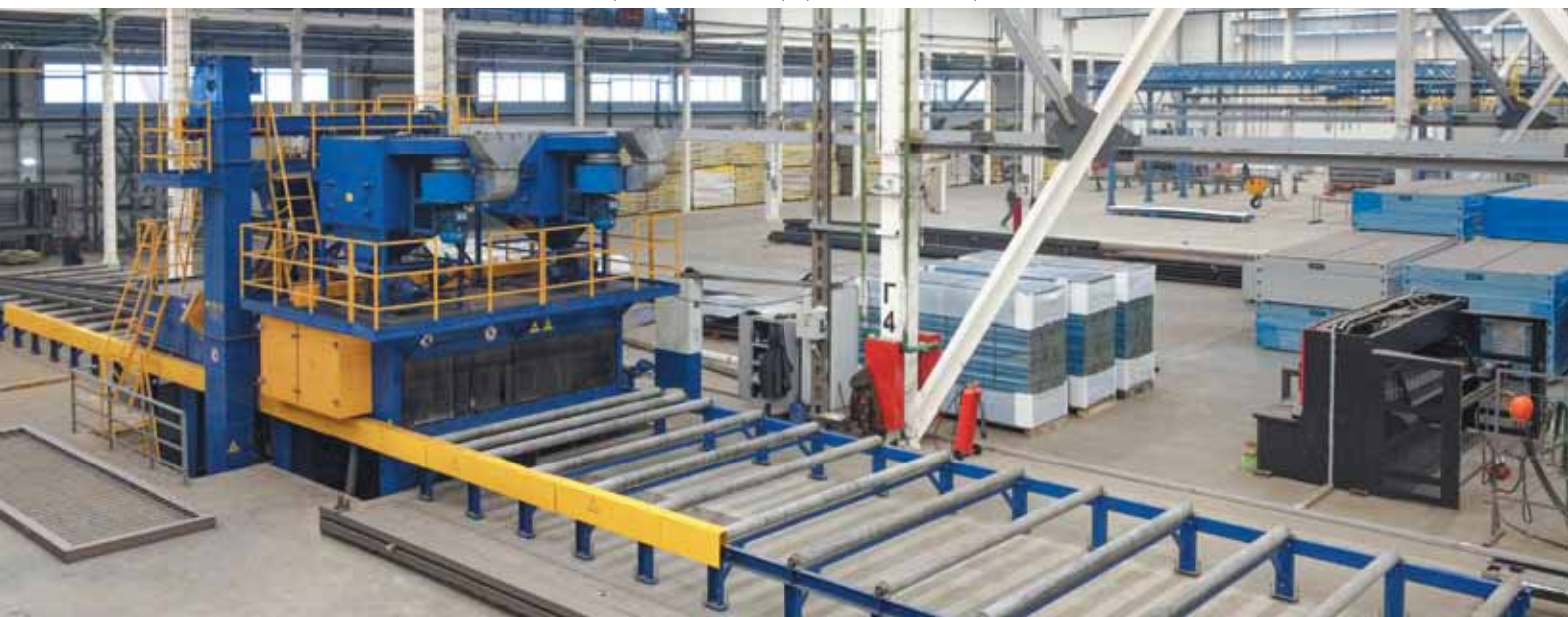
Завод полнокomплектных зданий, установка дробеметной обработки металла
