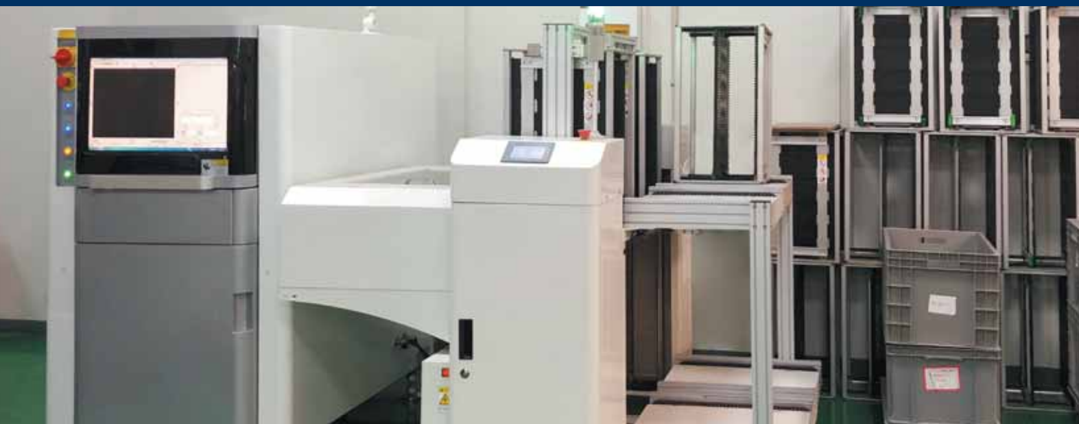
Завод электромеханики и микроэлектроники, участок контроля печатных плат
