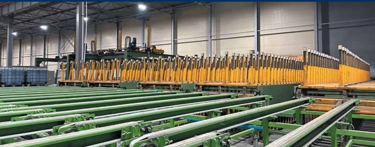
Завод стеновых и кровельных сэндвич-панелей, линия производства сэндвич-панелей PIR
