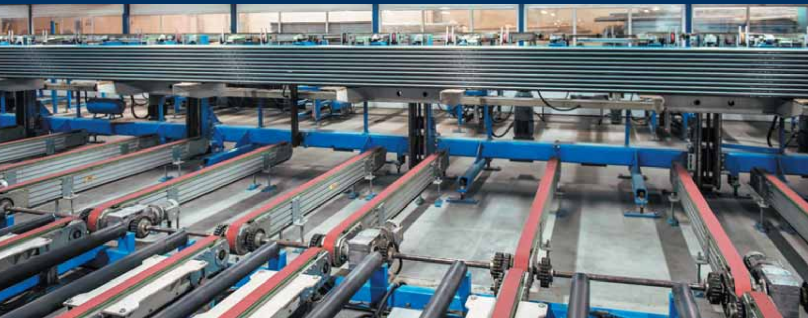
Завод воротных систем, автоматизированная линия по производству секционных ворот
