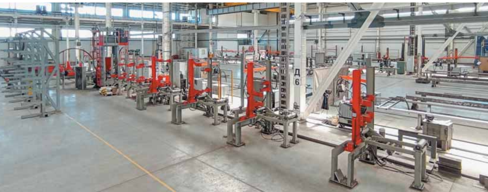
Завод блочно-модульных зданий, линия для изготовления сварной балки
