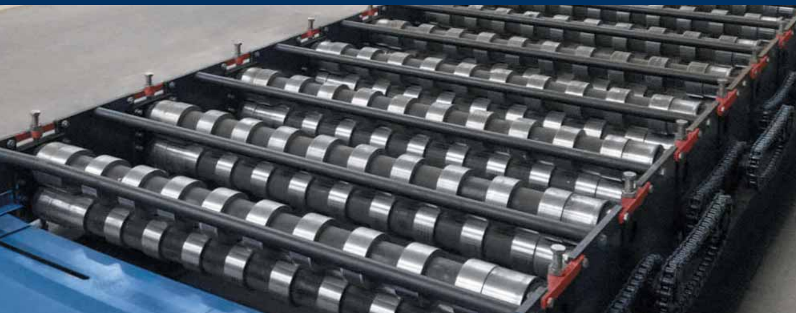
Завод блочно-модульных зданий, стан профилирования профлиста С8
