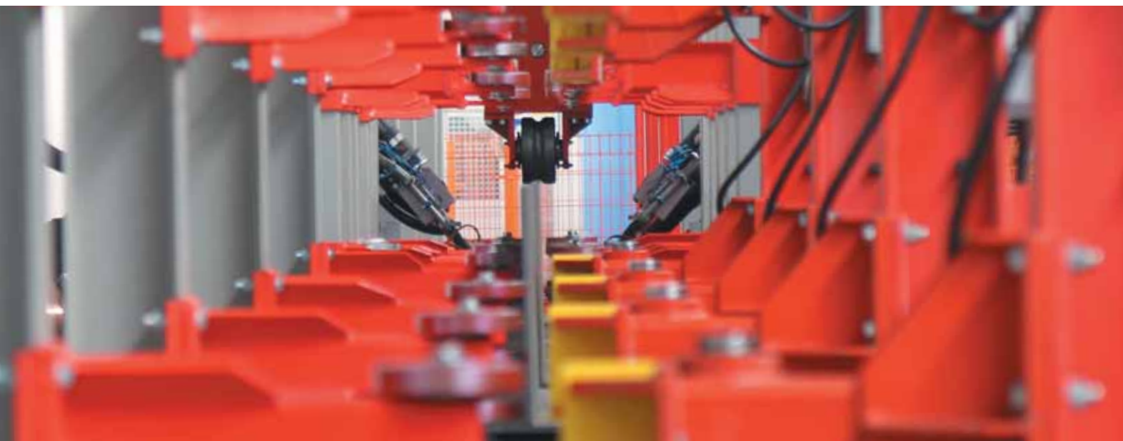
Завод полнокomплектных зданий, заготовительный цех, линия сварки балок
