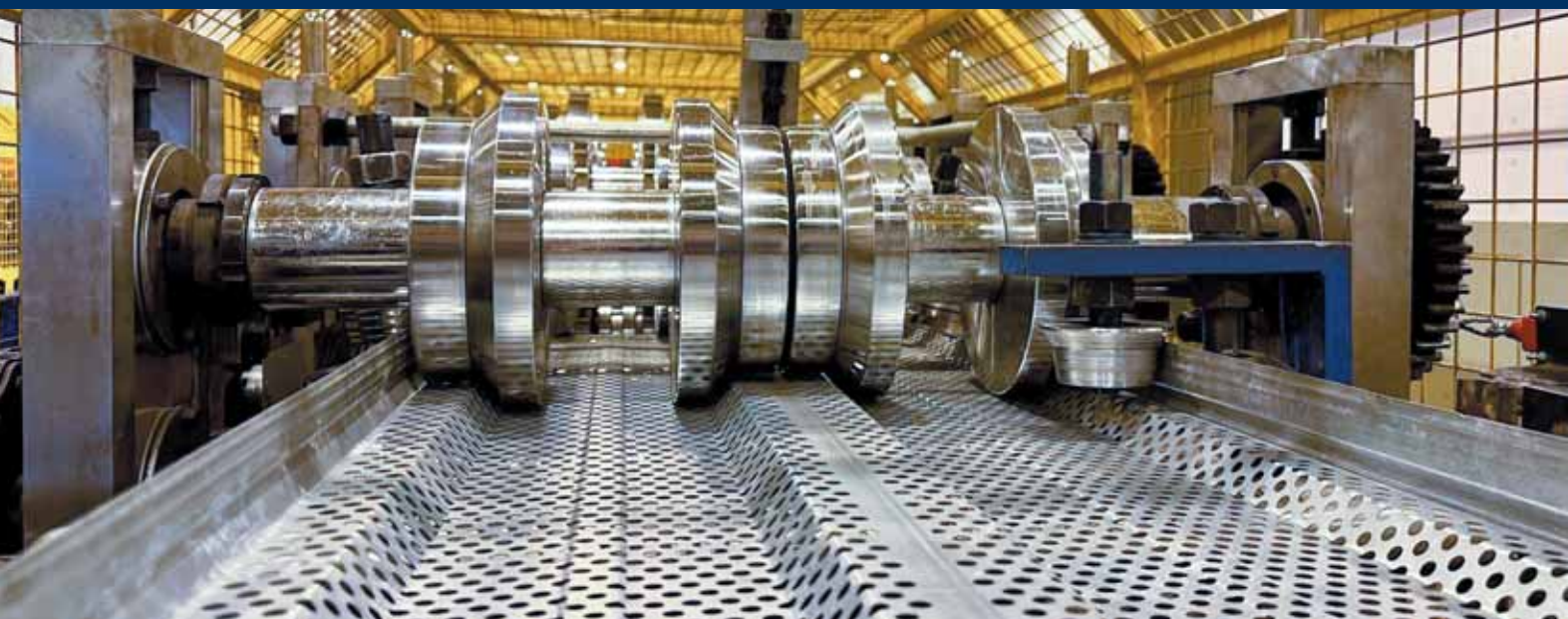
Завод акустических экранов, цех роликовой прокатки шумозащитных экранов
