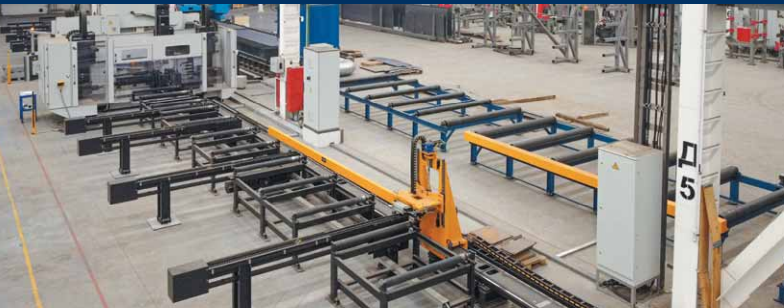
Завод полнокomплектных зданий, автоматическая линия сверления и пиления профильного металлопроката
