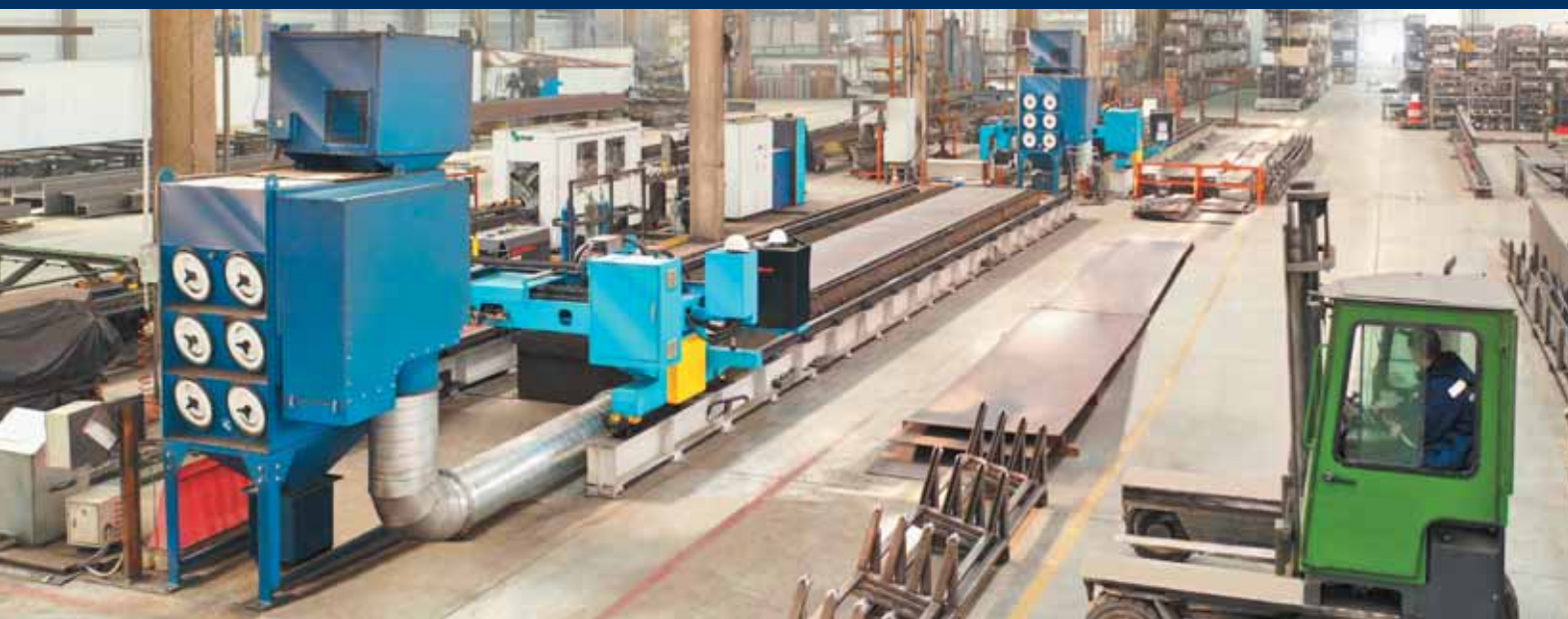
Завод полнокomплектных зданий, линии плазменной резки
