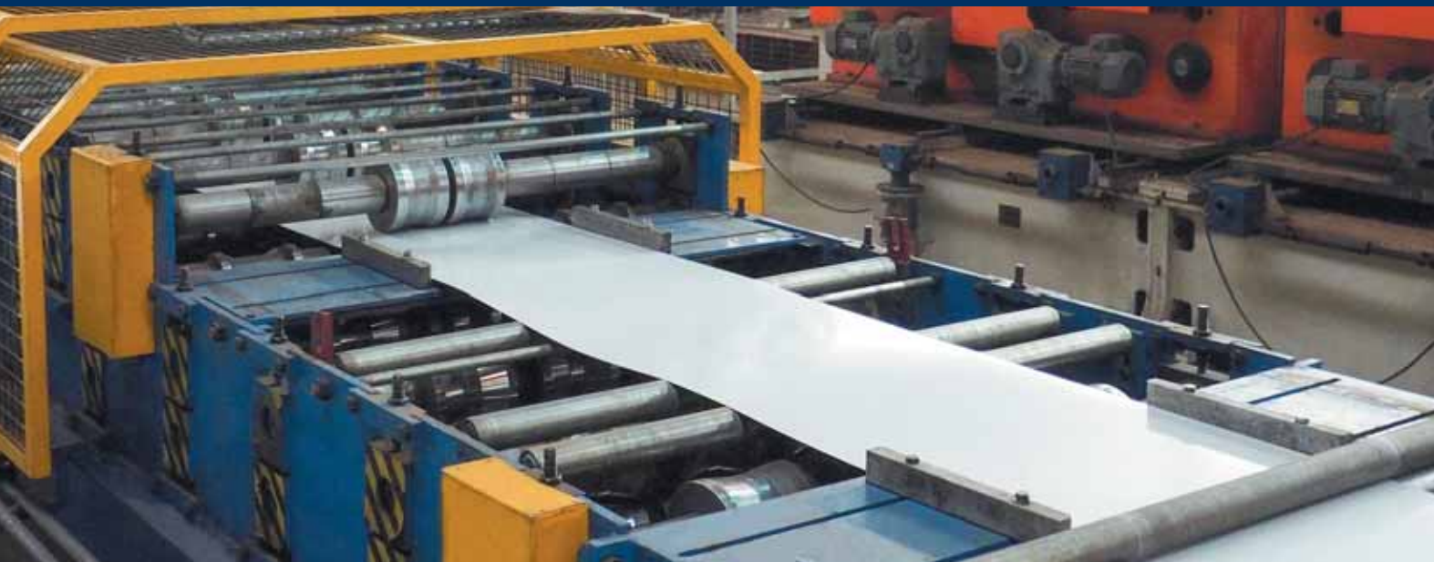
Завод полнокomплектных зданий, цех профилирования, линия изготовления 42-го профиля
