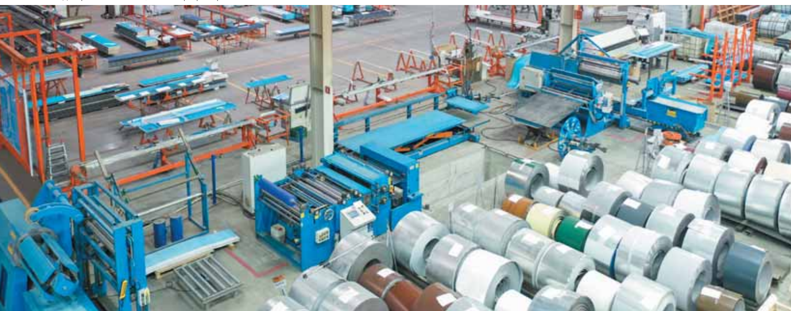
Завод воротных систем, линия поперечной и продольной резки рулонного металла
