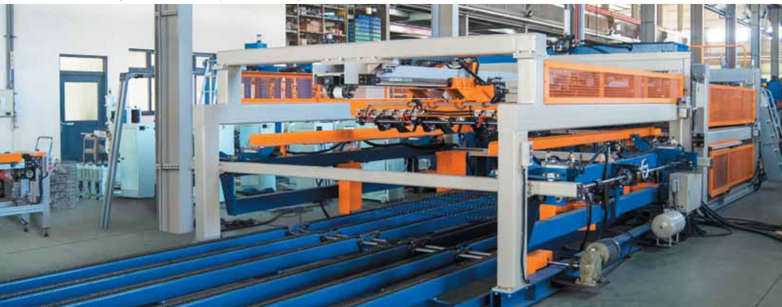
Завод систем ограждений, линия сварки и профилирования заборных сварных сеток
