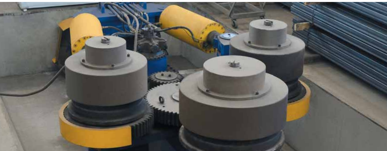
Завод полнокomплектных зданий, вальцы для изготовления труб большого диаметра
