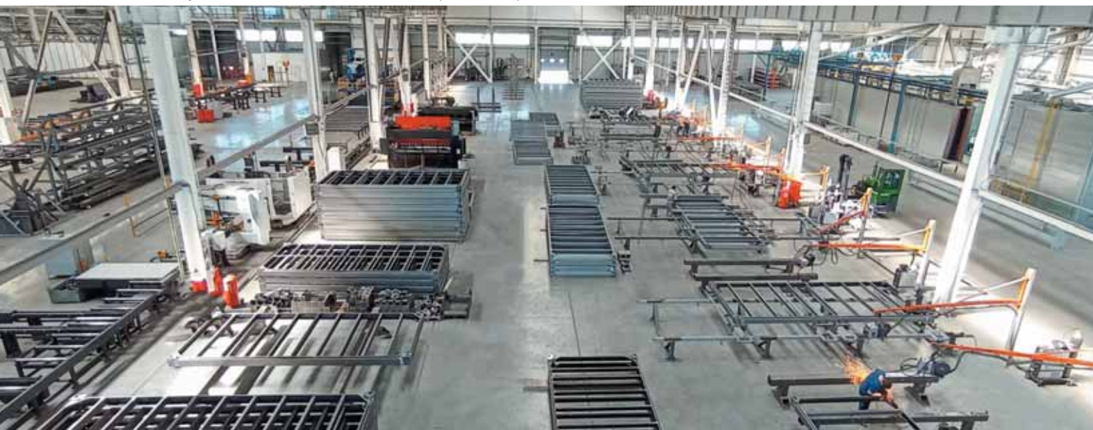
Завод блочно-модульных зданий, сварочный участок
