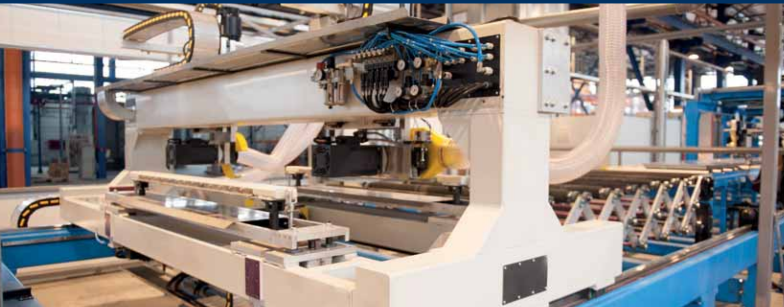
Завод дверных систем, автоматическая линия для производства дверного полотна, летающая пила для резки дверного полотна
