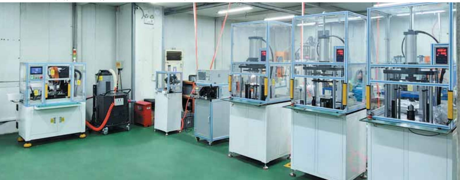
Завод электромеханики и микроэлектроники, линия по производству потолочных электродвигателей
